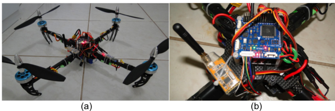
Figura 1 – Protótipo de VANT (a) e controladora CRIUS com radio APC220 (b)
