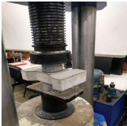
Figura 5 Ensaio de Compressão axial.
