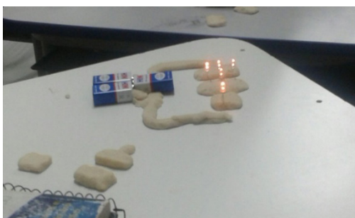
Figura 2. Circuito elétrico montado
