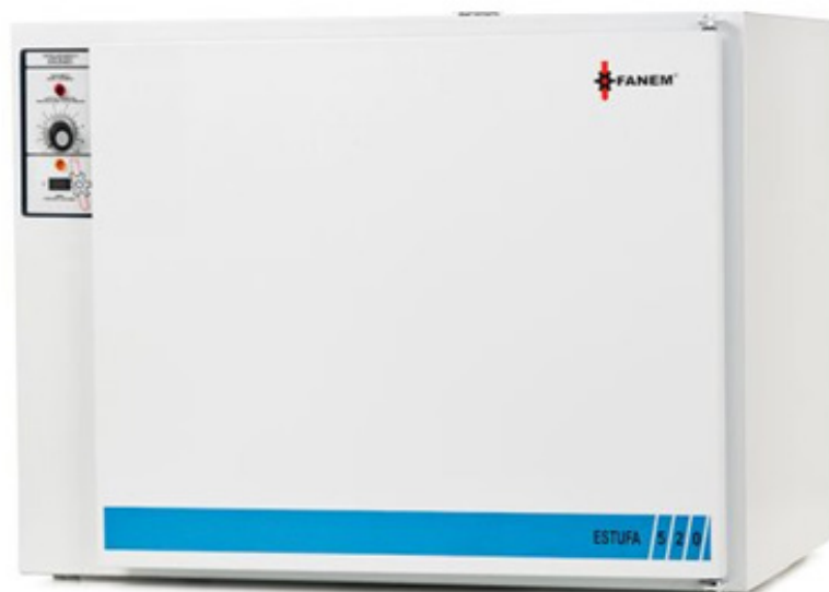
Figura 13. Imagem frontal da estufa de secagem com circulação de ar.
