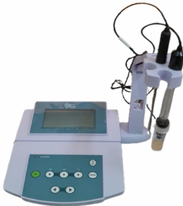
Figura 17. Imagem frontal de pHmetro de bancada
