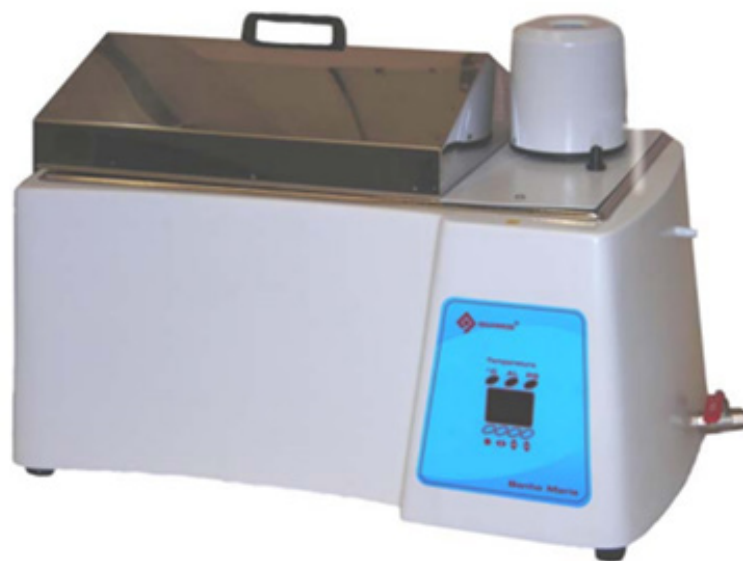
Figura 5. Imagem frontal do banho maria - modelo Q215M2.
