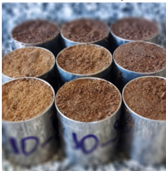
Figura 5. Coleta de amostras de solo com estrutura preservada (indeformada)
