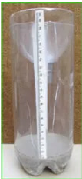
Figura 05. Pluviômetro de garrafa pet com fita métrica
